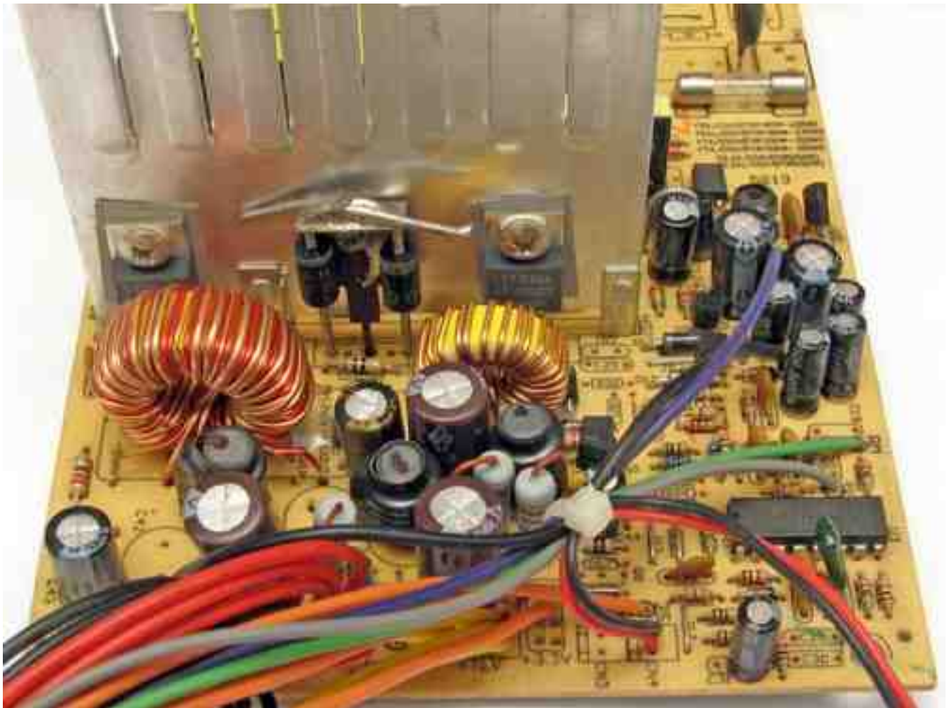
Рисунок 3 - Низковольтная часть блока питания. Вторичные выпрямители, электролитические конденсаторы и дроссели, некоторые из них отсутствуют.
