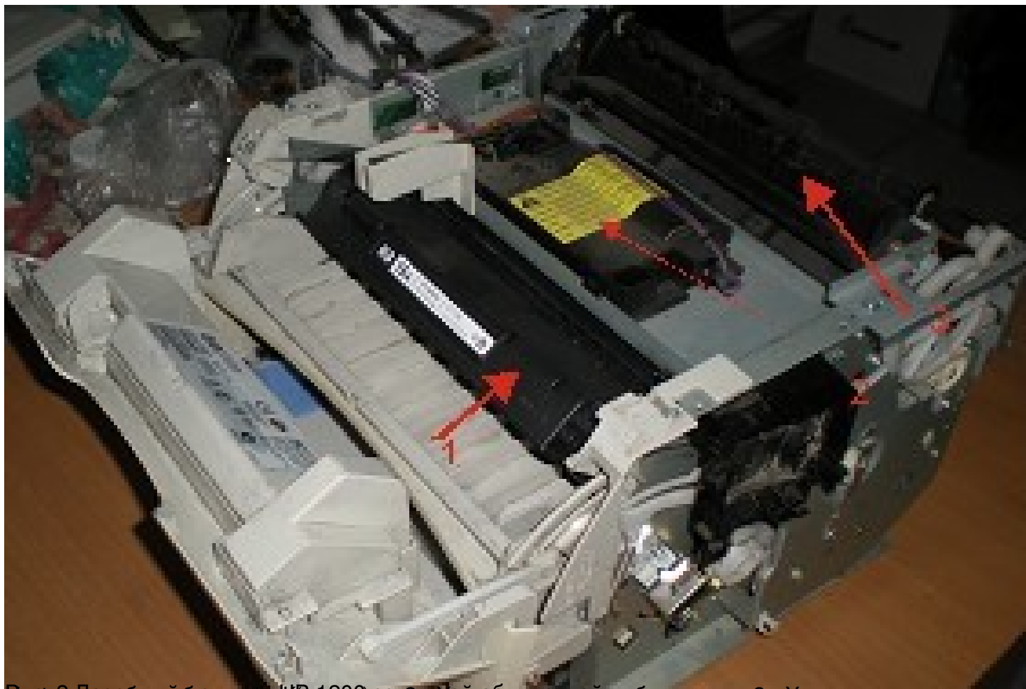
Вид сзади лазерного принтера HP 1200, 2 - Узел обработки изображения; 3 - Узел
