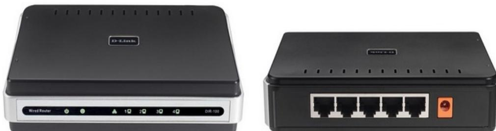
Принцип работы устройства довольно прост. Два его порта поддерживают NAT и функции межсетевого экрана. Эти порты предназначены для подключения персональных компьютеров и организации доступа к Интернет. Два же других порта не поддерживают функций маршрутизации – эти порты подключаются к WAN-порту в режиме прозрачного моста. К этим двум портам возможно подключить, например, IP-телефон или оборудование, необходимое для реализации услуги IP-телевидения (IPSTB).
